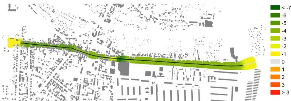
Abbildung 13: Isophonen-Differenzkarte Tag [Quelle: eigene Berechnungen] Reduzierung Lärmpegel dB(A)
