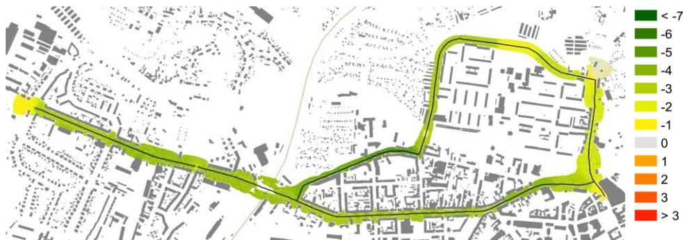
Abbildung 12: Isophonen-Differenzkarte Tag [Quelle: eigene Berechnungen] Reduzierung Lärmpegel dB(A)
